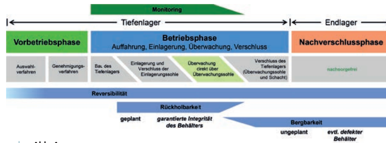
Abb. 4. Zeitliche Entwicklung einer HAW-Entsorgungsanlage mit Berücksichtigung einer langfristigen direkten Monitoringphase vor dem endgültigen Verschluss des Tiefenlagers und der Überführung in ein Endlager, in Anlehnung an Blommaert (2010) und Stahlmann et al. (2015) .
